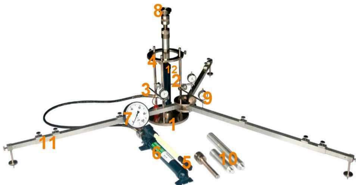
Rys. 1.1. Aparatura VSS z trzypunktowym pomiarem przemieszczenia płyty
